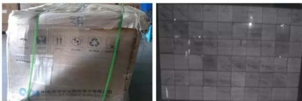
组件包装箱倾斜导致整体受力不均产生对角式隐裂
